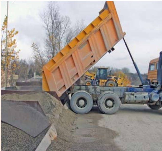
Befüllung der Boxen mit Gesteinskörnung in einer Asphaltmischanlage
